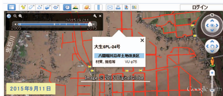
(図-8) 常総市の水利施設(パイプライン等)の可視化
